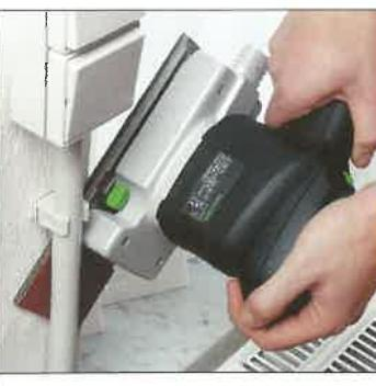
Brušenje za objekte brez demontaže
