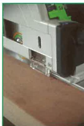
Pri novi **potopni krožni žagi** Festool TS 55 REB lahko **žagate pod kotom (od -1° do +47°)**, poleg tega boste z izboljšanim mehanizmom za nastavitev kotov le te nastavitevi hitrejše in natančnejše!
